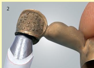
2 Les vernis espaceurs contiennent des composants métalliques. Ceux-ci génèrent des surfaces particulièrement résistantes à l'abrasion qui protègent le die contre de possibles dommages.
