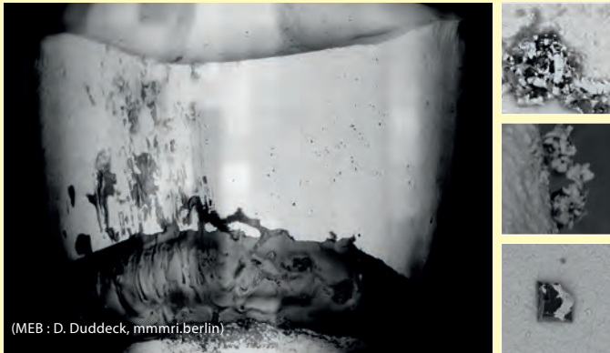
Clichés MEB de la partie sous-gingivale d'un pilier hybride
