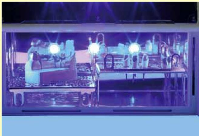
Объем камеры беспрепятственно позволяет разместить поворотный стол 2 bre.Lux UpDown, способствуя оптимальному использованию: модель на столе с более короткими ножками, культя на столе в обратной позиции и поэтому на более длинных ножках. Разность высот моделью и единичными культями – при приблизительно равном расстоянии от источника света – безупречно выравниваются с помощью UpDown.
