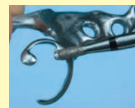
Заглаживание труднодоступных участков бюгельного протеза.
