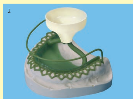
2 В процессе литья сжатый воздух вытесняется в воздуховыводные каналы, способствуя получению отливок без усадочных раковин, которые легко припасовывать.
