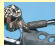
Заглаживание мест пайки или лазерной сварки.
